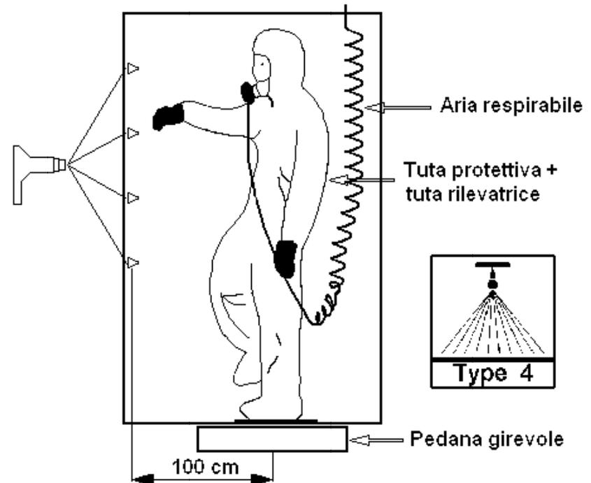
Pressione del liquido di prova al manometro: **150 KPa**
